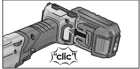
1. Introducir la batería cargada en la herramienta eléctrica presionando hasta que encastre por completo.
