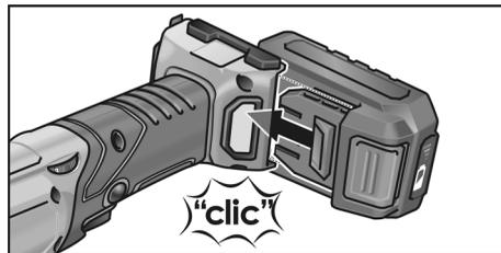
1. Insérez la batterie chargée dans l'outil électroportatif jusqu'à son emboîtement total.
