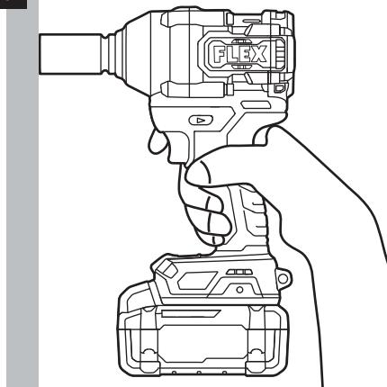
c. Presione el interruptor gatillo de velocidad variable para encender la llave de impacto. Comience lentamente, aumentando la velocidad a medida que la tuerca o el perno se aprieten. Ajuste firmemente la tuerca o el perno reduciendo la velocidad de la herramienta hasta que se detenga.
