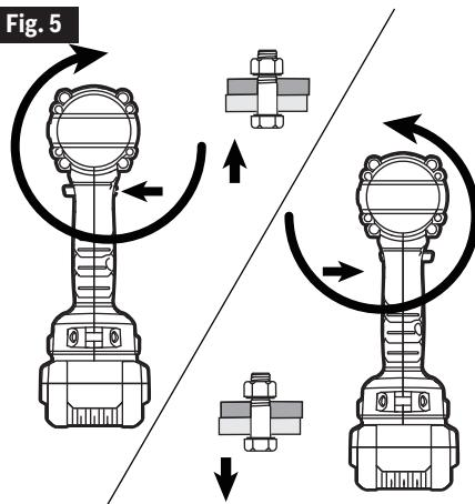
**AVISO:** La llave de impacto no funcionará a menos que el selector del sentido de rotación esté acoplado completamente hacia la izquierda o hacia la derecha.
