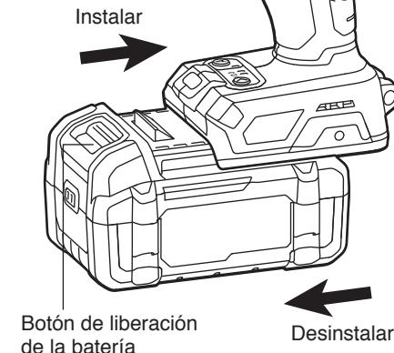
presión en la posición correcta. Una instalación incorrecta del paquete de batería puede causar daños a los componentes internos.
