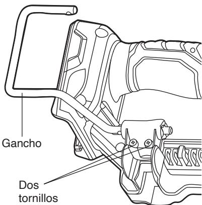
se puede transportar o colgar de una cuerda, un clavo y un pedazo de madera de 2x4 o de 3x6.
